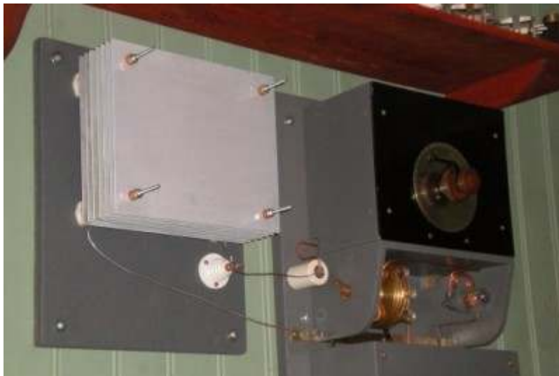
Bild 30. Konstantennen bestående av 350 pF i serie med ett 1 ohms motstånd skruvades fast i pärlsponten och anslöts till sändaren. 500 Hz generator inkopplad. Morsetangent ansluten. Kommer sändaranläggningen att fungera?
