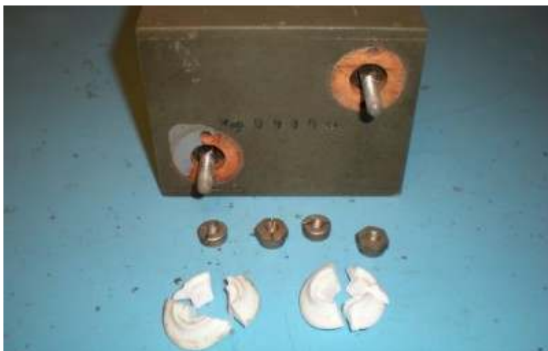
Bild 13. Kondensatorns märkvärde är 9930 cm vilket teoretiskt motsvarar 10400 pF. Uppmätt värde 10700 pF. De keramiska isolatorerna befanns vara spruckna på flera ställen. Bitarna limmades med Pro CA Superlim. Föreningen Experimenterande Svenska Radioamatörer www.esr.se
