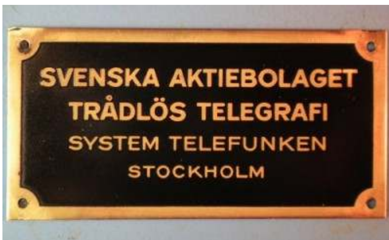
Bild 22. Skylten sprutades rakt över bokstäver och den omgivande kantlinjen. Då färgen härdat slipades förhöjningarna av med carborundum slippulver, kornstorlek 600, på en planskiva av glas.
