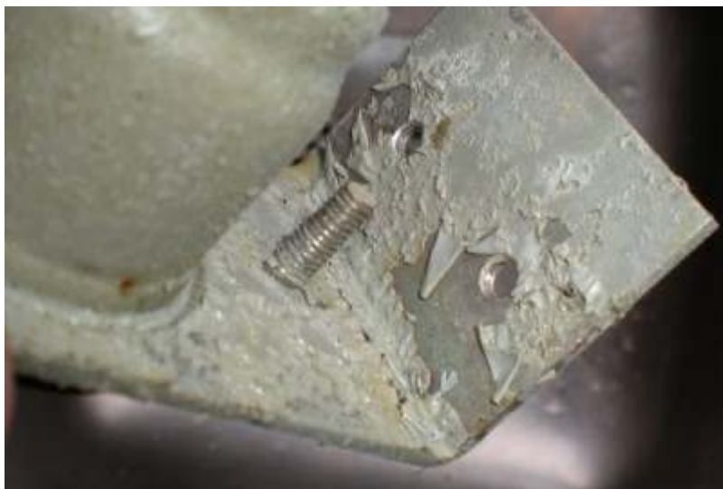
Bild 19. Efter en stunds puttrande så började färgen släppa taget. Efter ytterligare några minuter så fanns bara spridda färgflagor kvar, vilka petades bort med fingrarna.
