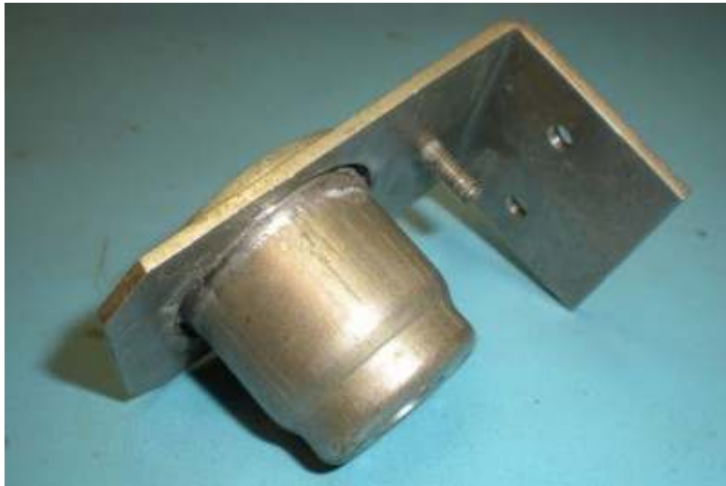
Bild 20. Den färdigkokta lamphållaren till antennströmsindikatorn klar att måla.
