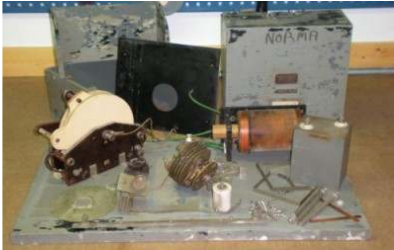
Bild 2. Gnistsändaren i lösa delar. Från vänster; variometern med spolarna för antenn- och gnistkretsarna, gnisträckan, högspänningstransformatorn samt gnistkretskondensatorn med två keramiska isolatorerna på toppen. .
