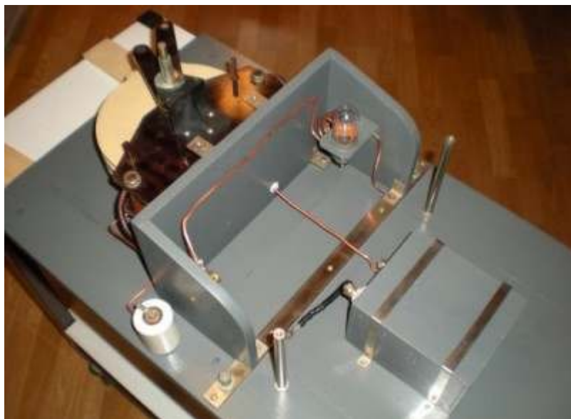
Bild 23. Variometern skruvades fast på hyllans ovansida och indikatorlampan på undersidan. Gnistkretskondensatorn (till höger i bild) monterades fast i bottenplattan med två U-bockade plåtremsor och mässingsskruv.
