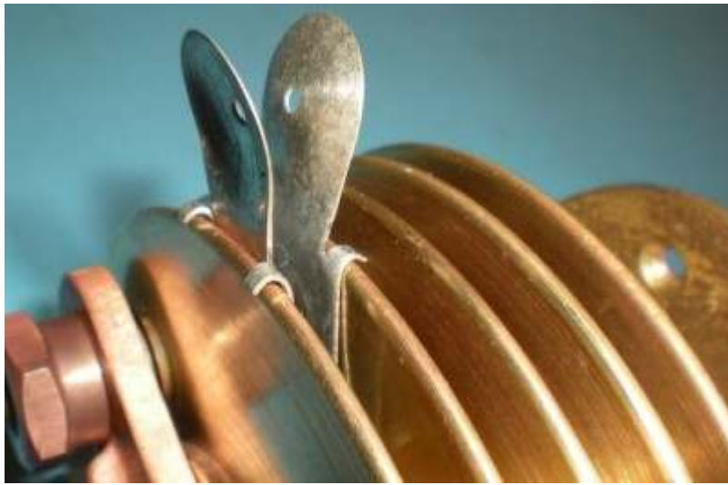
Bild 11. För att reglerar sändareffekten används kortslutningsklämmor. Tre klämmor, d v s endast en aktiv delgniststräcka ger lägsta uteffekt c:a 10 watt medan fyra delgniststräckor (alla klämmorna borttagna) ger full uteffekt c:a 150 watt (300 W generatoreffekt, 60 volt/5 Ampere, 50% verkningsgrad).
