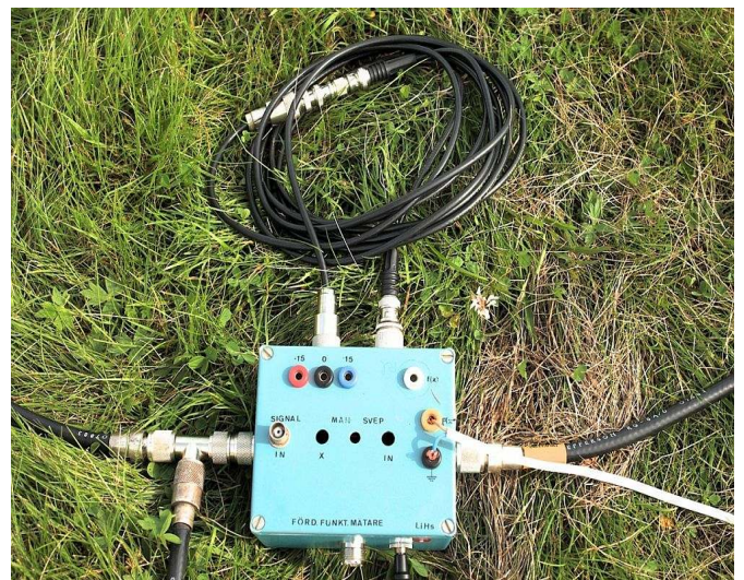
En återanvänd aluminiumlåda försågs i förväg med några SO239-kontakter och användes för reläerna. Man ser fasningskoaxen överst i bild, matningen till höger och vänster antenn samt sladden (vit) för manöverspänning (12 V) av reläerna. Lådan låg normalt insvept i en plastkasse för att skyddas mot regn. Reläerna var av enkel växlande sort från Biltema.
