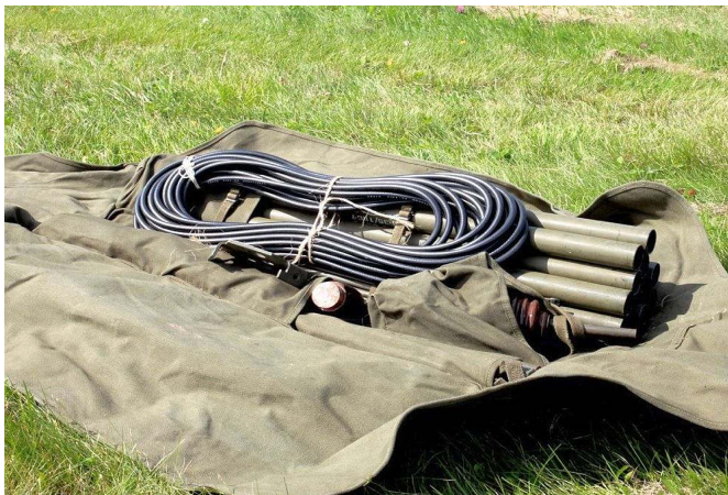
Den semiportabla masten TRC-7 i hoppackat skick. Satsen innehåller såväl mast som GP-antenn med antenn-spröt och 20 meter RG-213.
