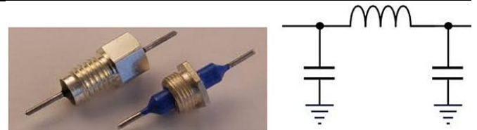
Bild 8-9: Genomföringsfilter med schema (PI-filter)
