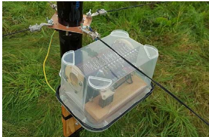
LC-nätet för impedansanpassning från 6 ohm till 50 ohm.
