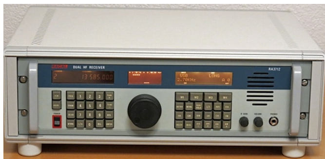
Exempel på mottagare i kontrollstation, Racal RA3712
