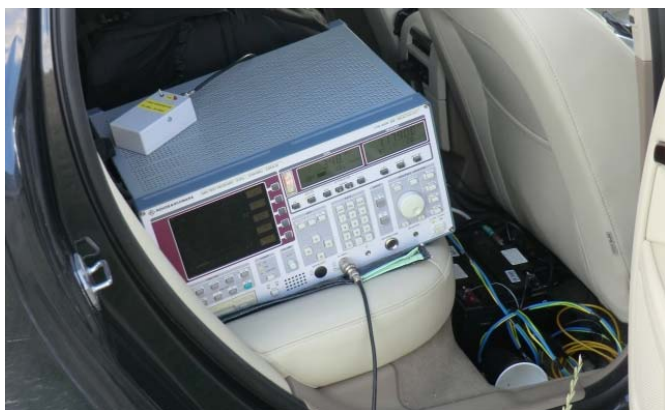
Mottagaren som vi använde var en Rhode & Schwarz ESCS-30 som ingår i en familj vanligt förekommande mätmottagare speciellt avsedda för EMC-provning.
