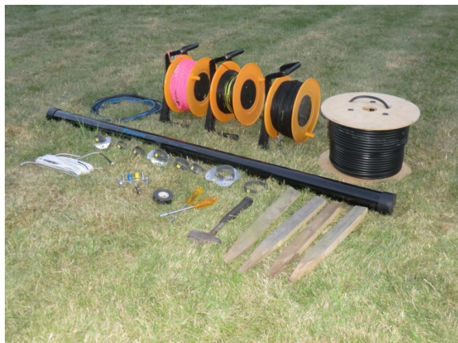
Antennutrustningen består av några få detaljer där staglinor, radialer och topplinor försetts med karbinkrokar och anslutningsöglor.
