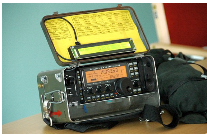
Portabelstation baserad på Elecraft KX3 komplett med två 4200 mAh LiFePO4 batterier och inbyggd loggdator med trådlöst tangentbord m m.
