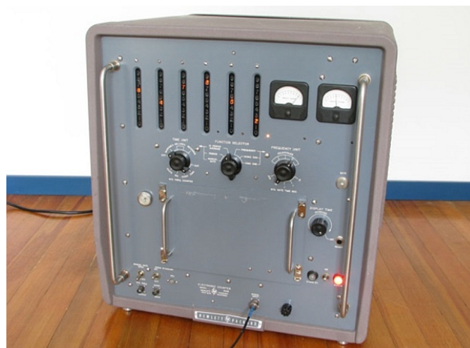
HP524A, en av de första kommersiellt tillgängliga frekvensräknarna
