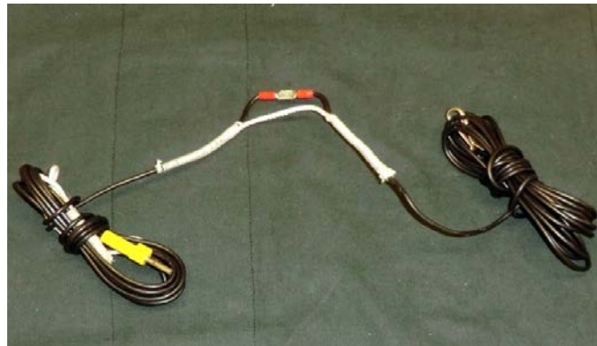
Radial 6,4 m lång med bygling på mitten.
