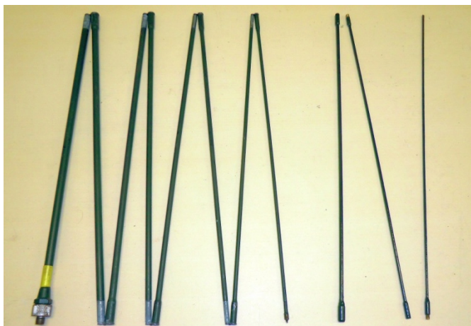
Ra200 antenn med tre extra sektioner. Total längd 4,8 m.
