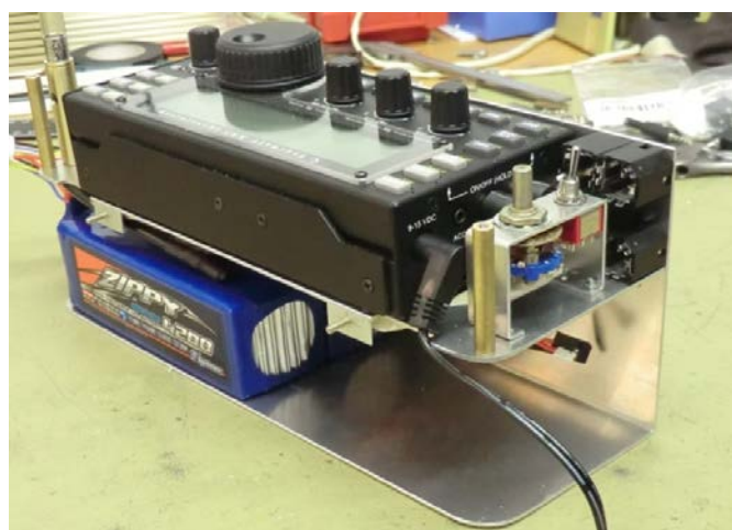
Det andra experimentchassiet till KX3
