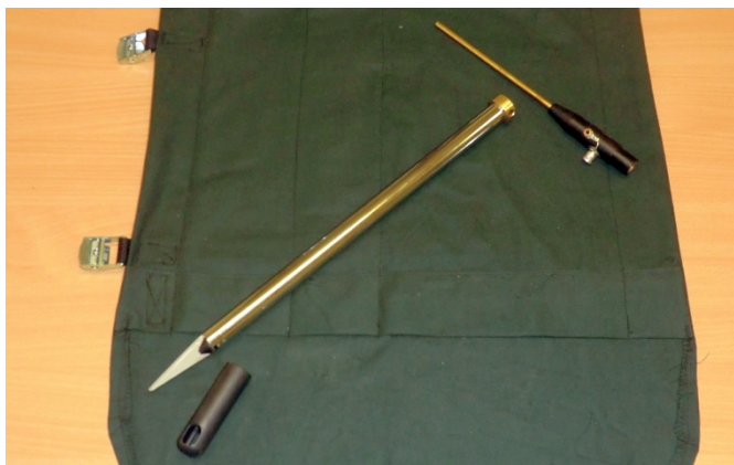
Med hjälp av en kort pinne (antennfästet) genom mässingshylsan så får man här en enkel jordbör med handtag som fungerar toppenfint att borra ner i marken och på sandstranden.
