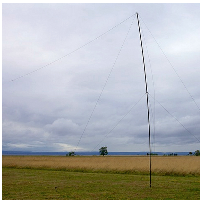
Fig 4. 40-metersvertikalen med ansluten horisontell del för anpassning på 80 m.
