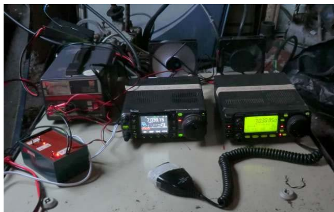
Två av radiofyrarna placerades i ett förråd c:a 300 m från stranden. Det krävdes ganska exakt 335 m grov koaxialkabel för att få fram 50 W till antennen ute på havet. Som firsändare används IC-7000 och IC-706MK2G som nycklas av två PIC-kretsar där meddelandet programmerats in. Den tredje firsändaren väster om Lund är en FT1000MKV Field som även den justerats för att lämna 50 W mätt i antennens matningspunkt.
