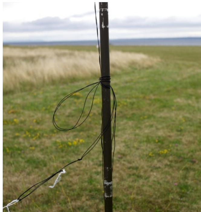
Fig 5. L-antennen för 80 m blir lätt en vertikal för 40 igen: Lossa den horisontella utlöparen och knyt fast den vid masten!
