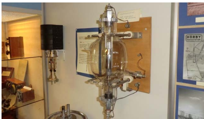
Lågfrekvenstriod MT9L från modulern i gamla KV-sändaren.
