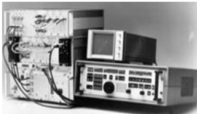
Fig 10. Pejlmottagare Telefunken 8 eller PGS 1520 med manöverenheter BG1520/E. Telefunken 8 är pejlvvarianten av E1800.
