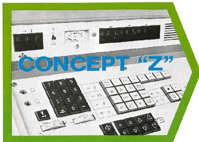
Fig 6 Centralmanöverenheter BG1200/Z (märk den inställda frekvensen)
