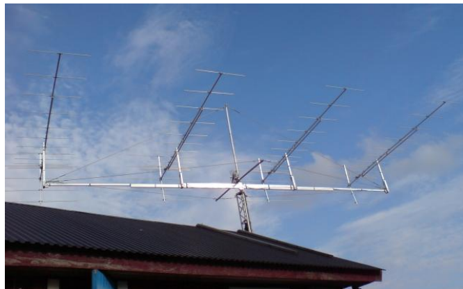
Fyra stackade FM17.5 hos Kjell "Kelly" Lindman i Skurup. Max. förstärkning 18,4 dBi med smal huvudlob.
