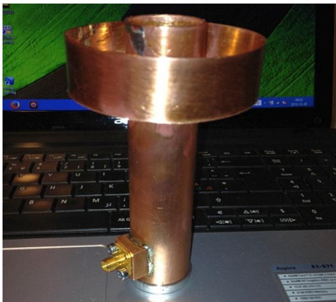
Linjärt polariserad Kumar-matning. I mitt fall orienterad för horisontell polarisation.
