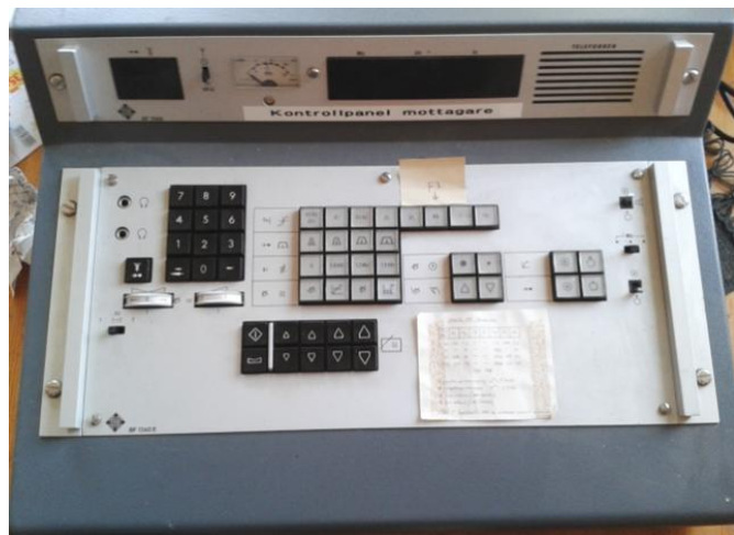
Fig 7 Manöverenheter BG1200/Z å Stureby Radio.
