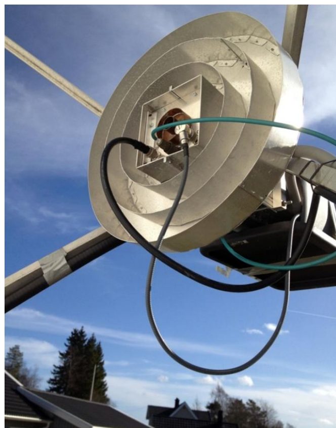
Konverter byggd för att passa inuti 23cm-mataren. Kablarna är för spänningsmatning, LO och MF.
