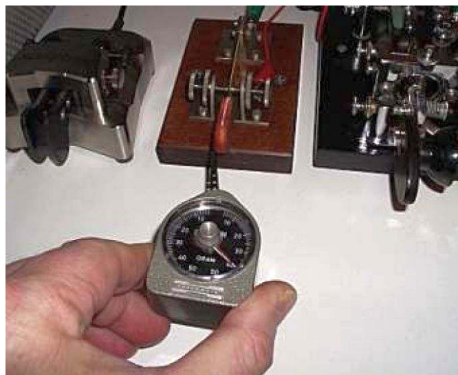
Kraften som behövs för att göra kontakt är med bågfilsladet uppmätt till 40 gram.
