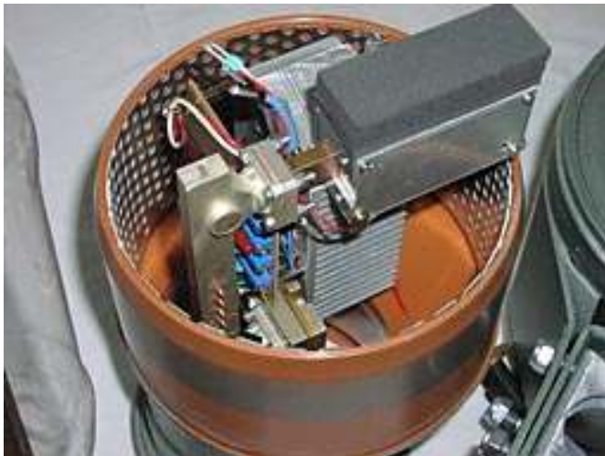
PA+filter+dubblare och DC-reglering.
