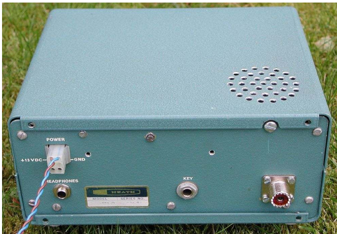
Antennkontakten, som i original var en s.k. phono-kontakt, har jag bytt ut.
