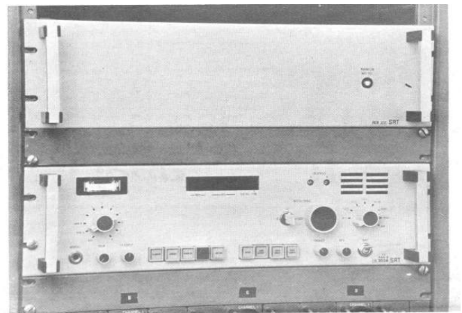
Mottagare CR303B + fjärmanövermottagare RCR300 använd för fast trafik vid Enköping Radio 1973. Just detta exemplar finns fortfarande kvar där (oktober 2010).
