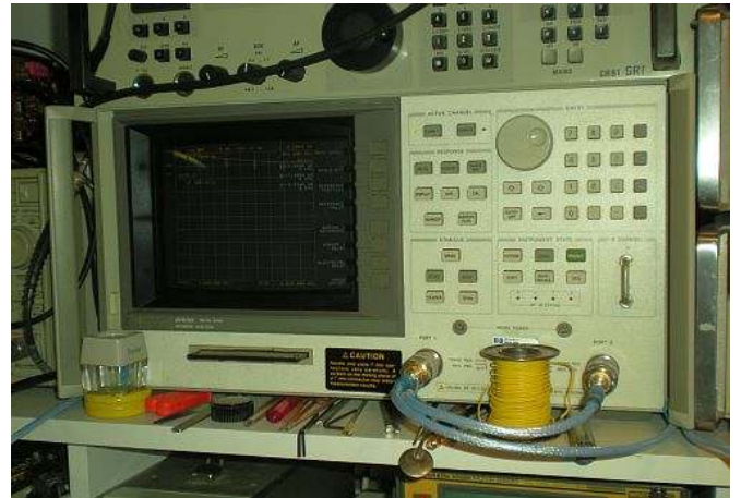
Nätverksanalysator HP8753D (Täcker 30 kHz - 3 alt 6 GHz)
