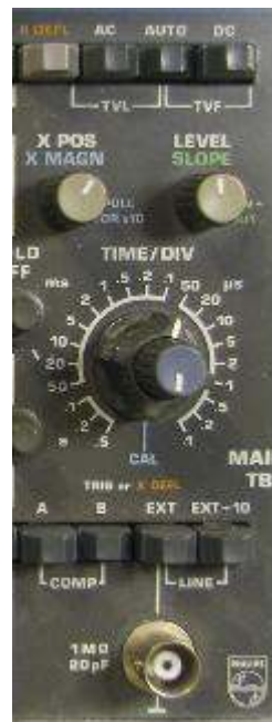
Triggförstärkaren styr "avfyringen" av svepet
