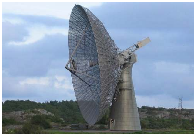
25 meters teleskopet byggdes i mitten på 60-talet och användes initialt för de första telesatellitexperimenten i Sverige i 4 GHz bandet.
