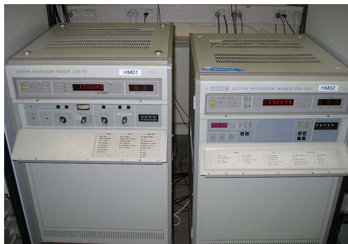
Råös två Vätemasrar. Fabrikat "KVARZ". Tillverkade i Ryssland.
