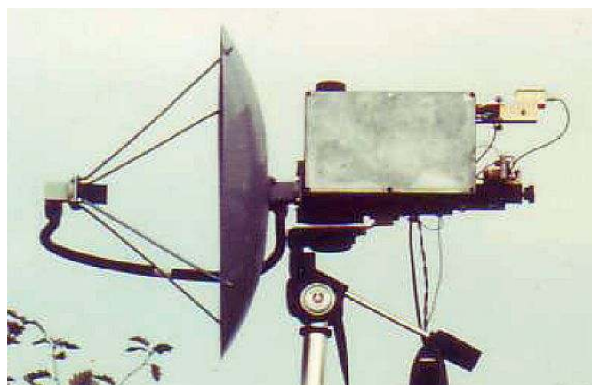
Min andra 10 GHz station byggd 1984. Uteffekt 8 mW. Mottagaren bestod av en detektor med 1N23C plus lågbrusig MF-förstärkare för 432 MHz.
