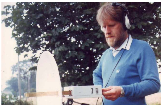
Ole OZ9TM med sin mycket kompakta helt hembyggda 10 GHz station. (MARC:s Field Day i Gödelöv tidigt 80-tal)
