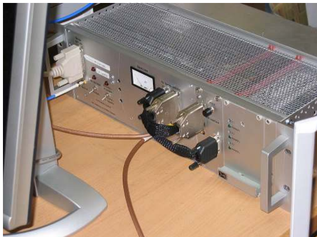
IF-systemet till den radiometern som PLL-artikeln i detta nummer av ESR Resonans avhandlar.
