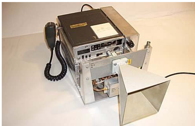
Multiplikatorkedjan från 92 MHz till 1104 MHz. Uteffekt +30 dBm.
