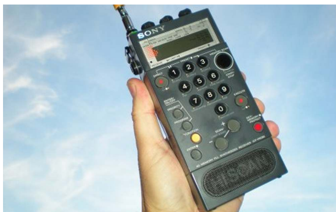
Sony ICF PRO80. Populär "världsradiomottagare" täckande 150 kHz - 30 MHz plus FM-bandet. (Foto Bengt Falkenberg)
