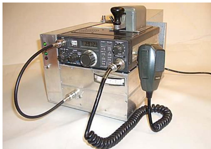
Portabelstation för 10 GHz CW/SSB/FM byggd av Bengt SM7EQL 1985-86.
