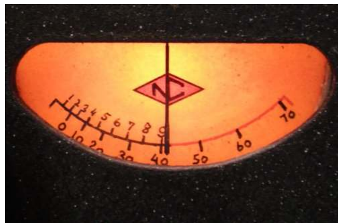
Bild 2. S-meter med individuellt kalibrerad skalgradering, National NBS-1 mottagare tillverkad 1952.
