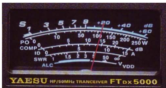
Bild 1. S-meter i en modern transceiver, FTDX 5000
