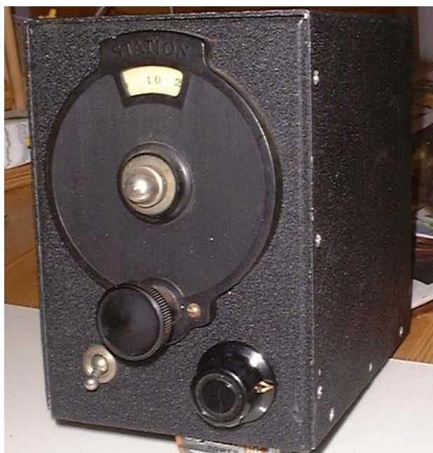
SM5YM:s raka 2-rörs mottagare
