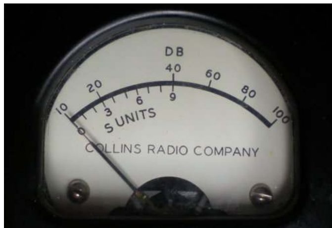
Bild 4. S-meter på Collins 75S-3B mottagare tillverkad 1963-1975.
