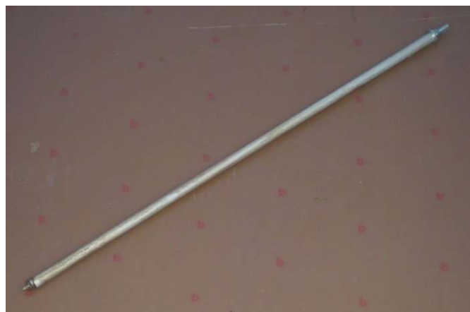
Bild 1. Mätproben är 460 mm (18") lång och tillverkad av 9.5 mm aluminiumstång. Proben trycks eller slås ner i marken så att enbart anslutningsgången exponeras ovan mark. Gängen syns upp till höger i bild. Till gången skall antennanalysatorn
