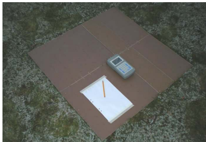
Bild 2. Som referensjordplan använde jag några överblivna skivor enkelsidigt glasfiberlaminat som popnitats ihop och försetts med ett långt pianogångjärn på mitten. På så sätt kan jordplanet enkelt vikas samman för att lättare transporteras och stuvats undan. Yttermåttet blev 91 x 91 cm vilket motsvarar 3 x 3 fot enligt Rudis beskrivning.
