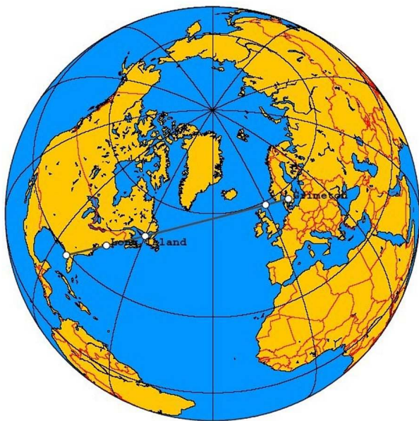
Figur 1: Storcirkeln från Grimeton till Long Island, New York med ortografisk projektion, som innebär att jorden projiceras på ett plan, som tangerar jordytan på en punkt, i detta fall 30 grader väst och knappt 60 grader nord, vilket är halvvägs. Då blir storcirklar genom denna punkt räta linjer.
