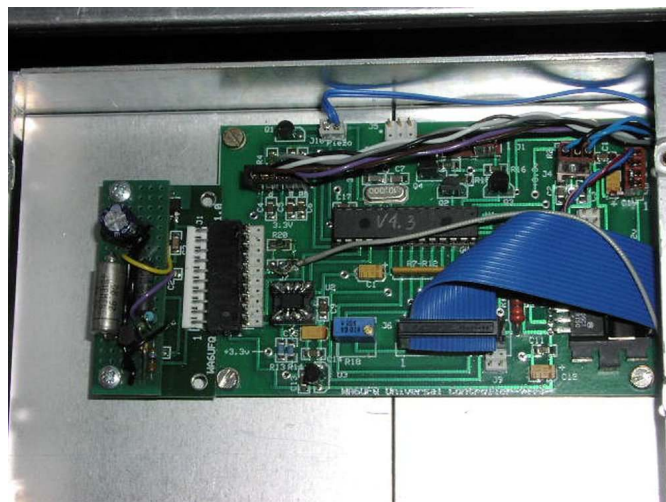
Bild 3: Här är minneskretsen synlig lödd på DIL8. Kortet är i sin tur placerat i boxen för de tidigare stående syntkortet.
