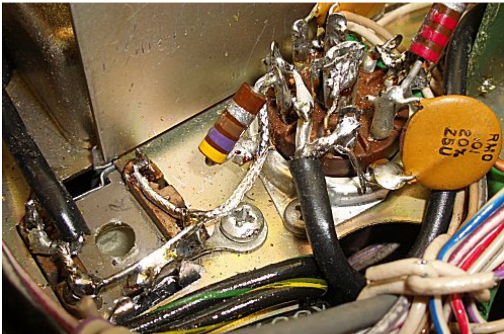
Fig 14. T6 (till vänster i bild) är åter på sin plats. Skärmplåten som tidigare var monterad på rörhållaren (V4) har tagits bort eftersom den inte längre behövdes.
