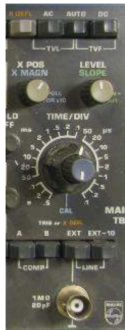
Triggförstärkaren styr "avfyringen" av svepet
