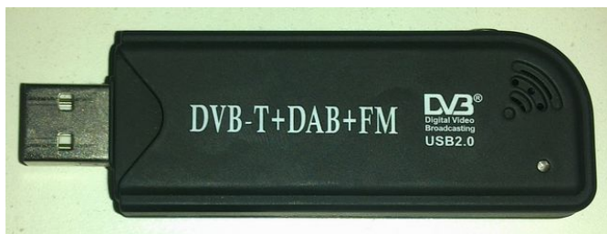
Bild 1: RTL-SDR R820T USB-mottagare
