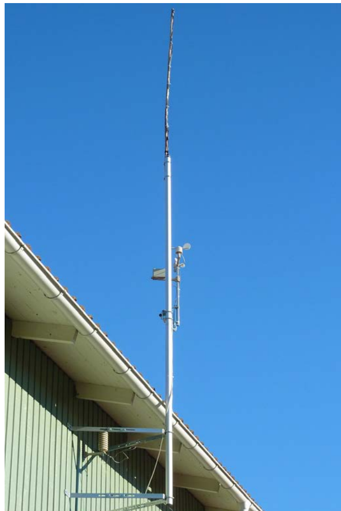
Bild 5: N9TAX Slim-Jim-antenn monterad i toppen på 3 meter maströr.
