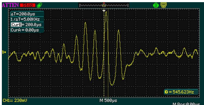
Varje enskild störpuls är c:a 200 µs lång och det kommer 5-6 sådana i varje halvperiod.
