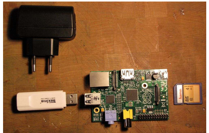
Kortet med tillbehör för fjärrstyrd SDR-mottagare, sladdar och antenn tillkommer
