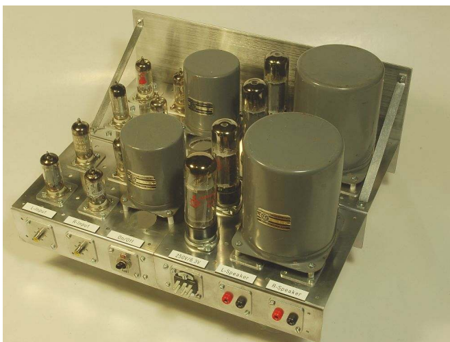
Bilden ovan visar en provmontering av en rörbestyckad push-pull stereoförstärkare med 4 st EL34 som slutrör.
