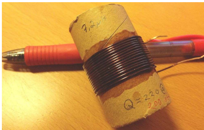
Bild 2. Spolen färdigglindad och lackad. Induktansen uppmättes till 7,2 uH och Q=200 efter lackning.
