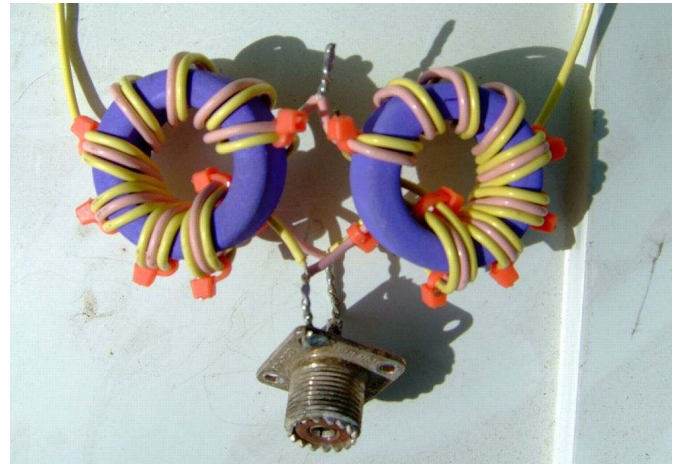
Bild 1. 1:6 Guanella-balun tillverkad av SM6APQ.
