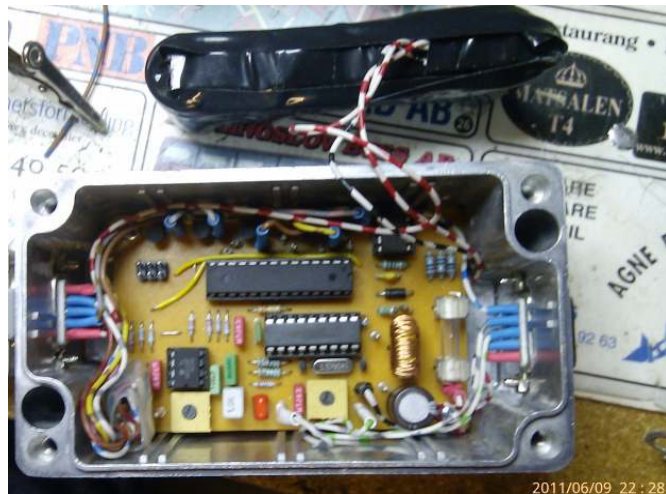
Styrlogik med DTMF-mottagare.
