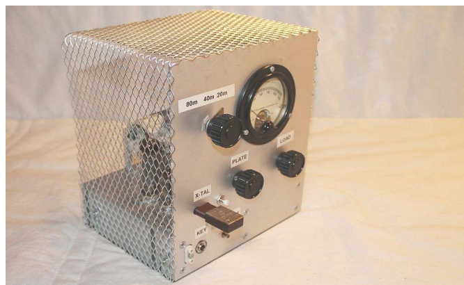
Enkelt galler från Billema som skärm. Kristallhållare för FT-243- och HC6U-kristaller.
