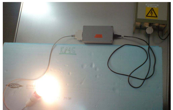
Testobjektet anslutet via ett nätfiltre till den s.k. LISN.
