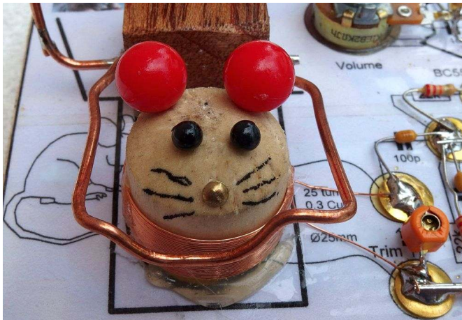
Bild 1. Permeabilitetsavstämmd oscillator, lite dekorerad med nålar för anslagstavlan.
