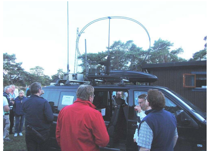
FMV ställde ut en bil som lockade till sig många nyfikna deltagare. På denna bild är både loop-antenn och whip-antenn för HF synliga.
