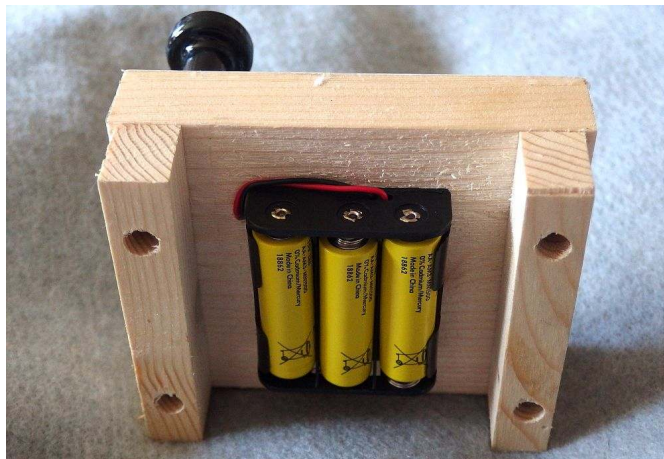
Sändarens Power Pac, tre batterier av typen AA/R6/MN1500 ger sändaren en uteffekt av 300-400 mW, ökas spänningen till 10 volt blir uteffekten 1-2 watt.
