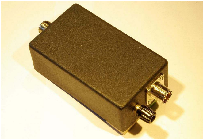
Mantelströmdrossel inbyggd i plastlåda
