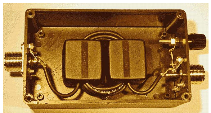
Två klämferriter och en bit RG174 koaxialkabel
