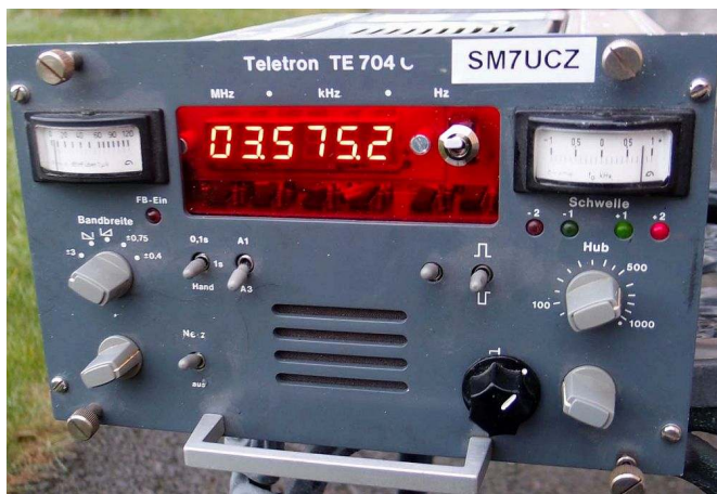
Modifierad Teletron med VFO-ratt och LED-display
