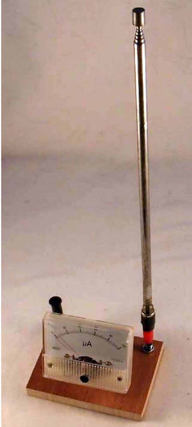
Passiv fältstyrkemeter med germaniumdiod och 100 uA vridspoleinstrument.
