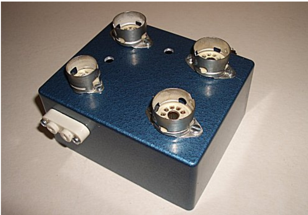
Bild 3. Rörhållarna, spolen och kristallhållaren är på plats.
