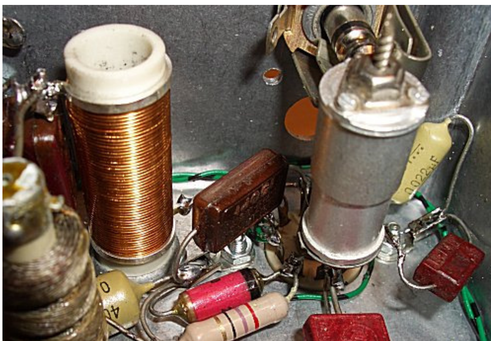
Bild 7. Slutsteget med EL84 innehåller lika få komponenter som oscillatoren. Några resistorer och kondensatorer.
