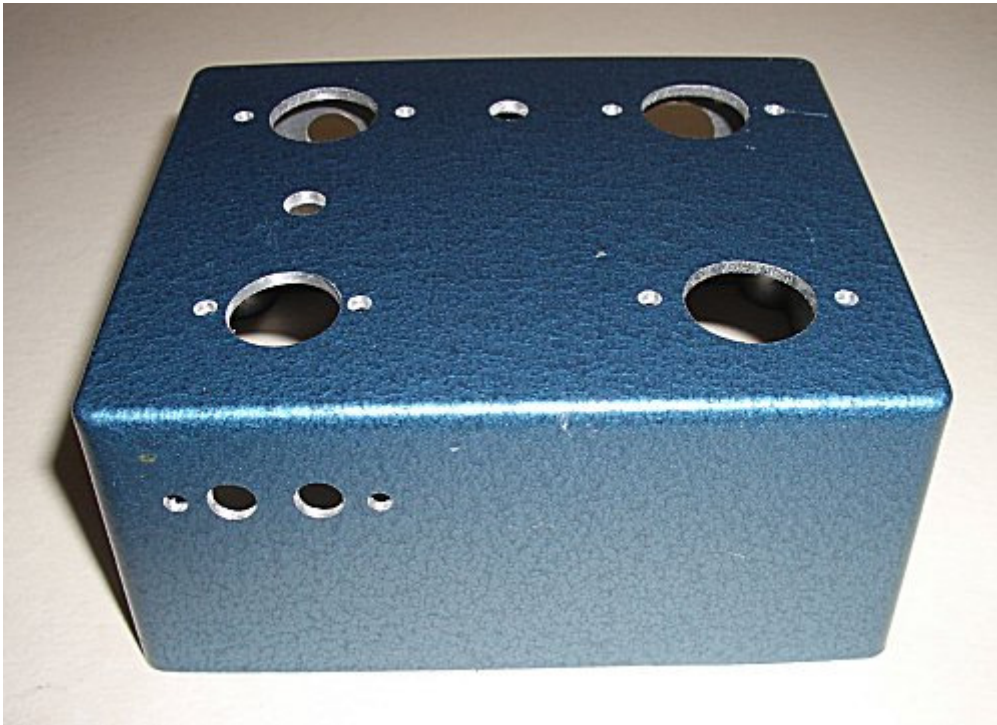
Bild 2. Att borra i siluminboxar är som att borra smör. Silumin är en legering som består av 87% aluminium och 13% kisel. Med vassa borrar får man korta spånor och snittytan i hålen blir skarp och fin. En droppe T-röd på borrar som smörjmedel skadar inte heller.
