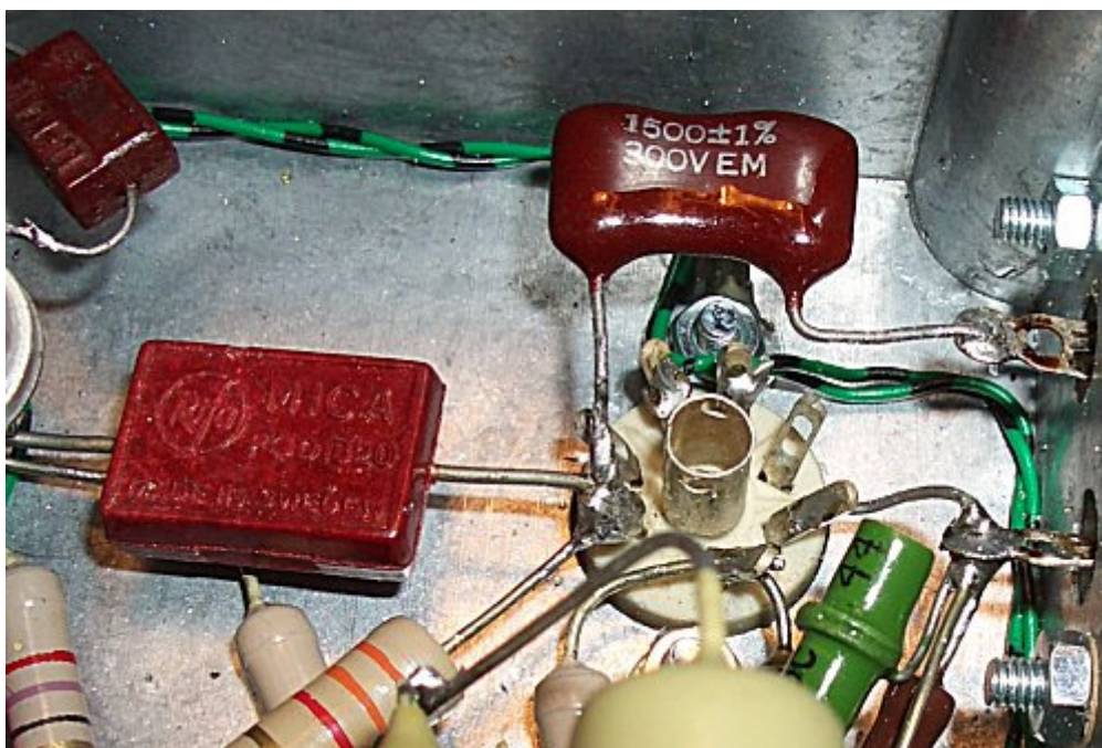
Bild 6. Som oscillator används trioden EC90. Till höger i bild ses anslutningarna till kristallhållaren. Till vänster ses kopplingskondensatorn mellan oscillator anod till slutrörets styrgaller.
